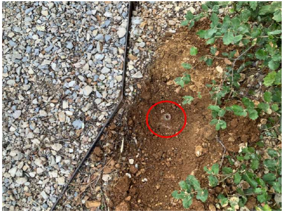
3. Borne OGE au centre de la limite entre les terrains.
